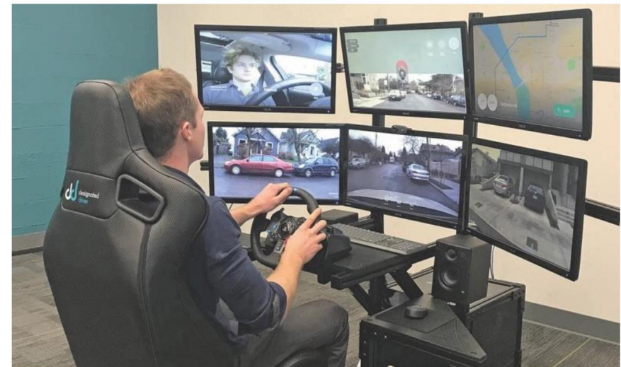
Bild 4: Remote Cockpit für Teleoperation [5]
